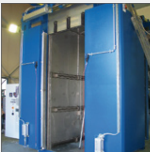
Gas Ofen (500 C) als Beschichtungstrockner Gas heated furnace for surface coating
